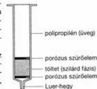
5.4. ábra. Az SPE oszlop felépítése
